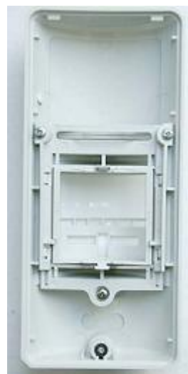
13. ábra: Beszerelt kisállat elleni szűrő
