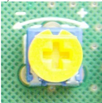
8. ábra: PIR érzékenység állítás
